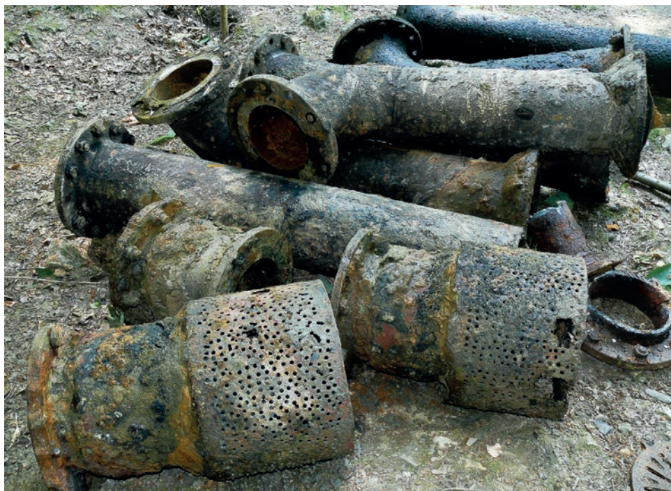
7. ábra: A barlangból kisserelt csővezetékek
